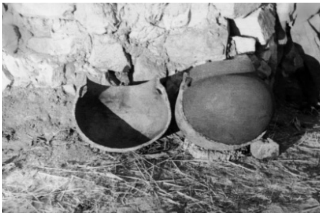
Fig. No. 120.- Alfarería moderna. En la vista aparece uno de los moldes separados. Nótese la forma de la vasija, que aún permanece adherida al otro molde.
