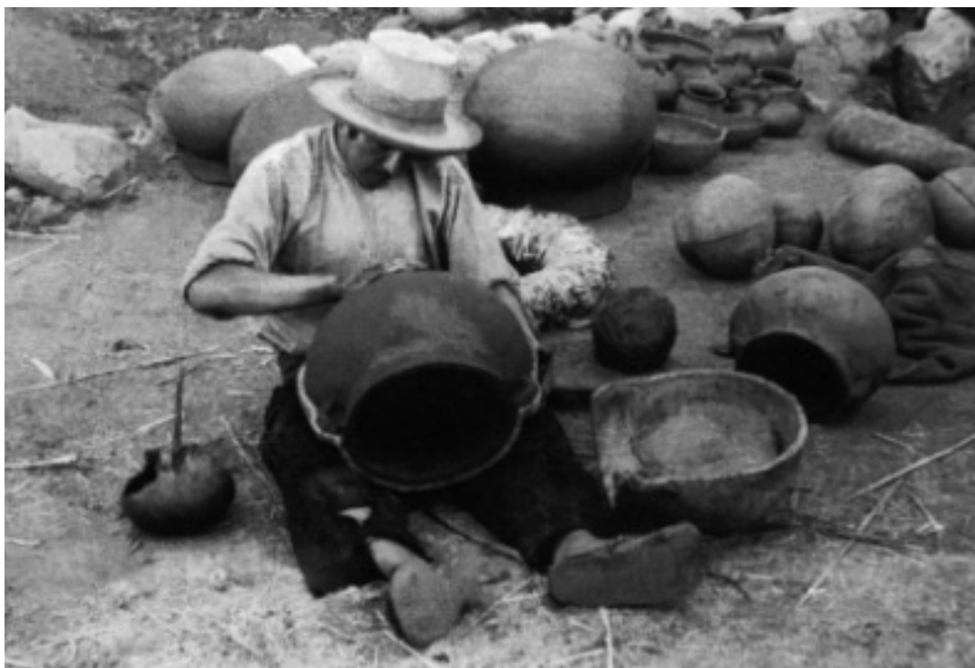
Fig. No.122.- Alfarería moderna. Momentos de la resanación de los pequeños defectos de la vasija, rajaduras, "pispados".
