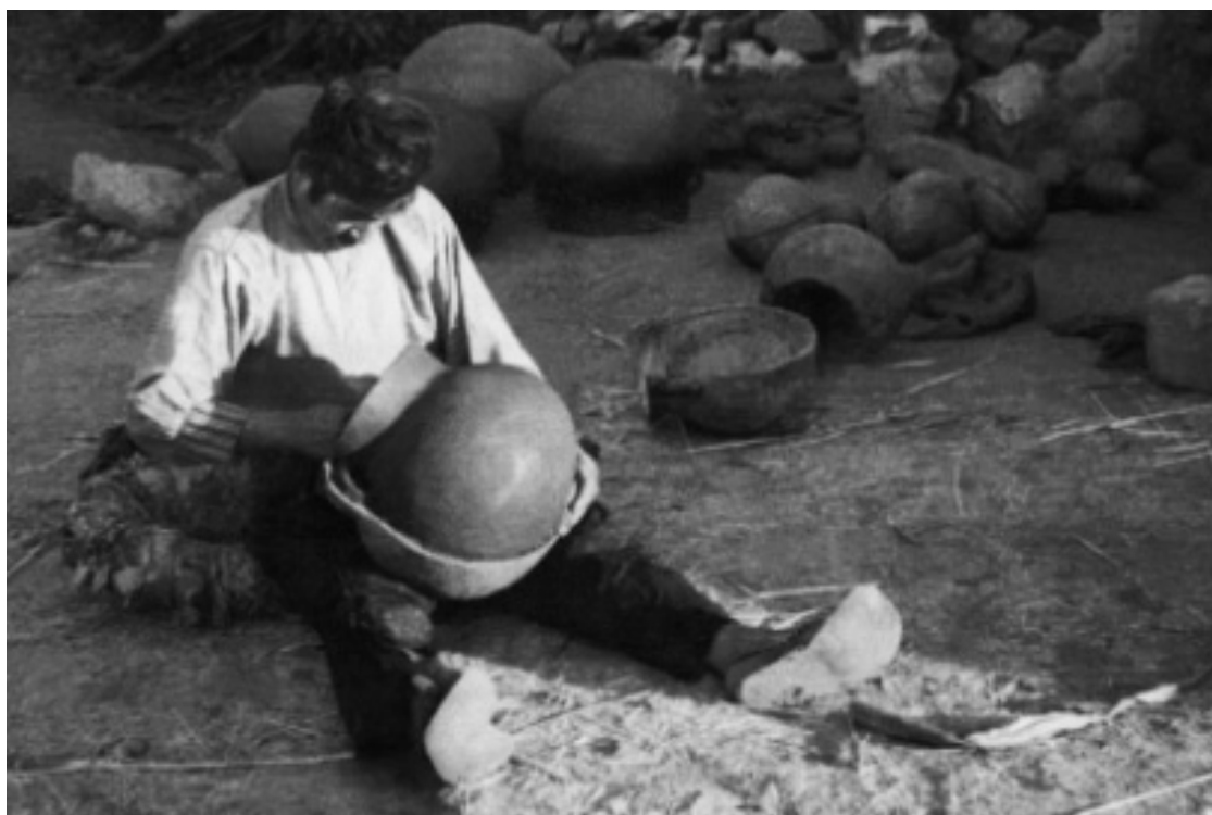
Fig. No. 121.- Alfarería moderna. Instantes del retocado de las juntas, antes de sacar la otra parte del molde.
