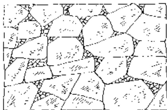
Fig. No. 227.- Aparejo pétreo. Pirca de piedra aristosa, apachillado.
